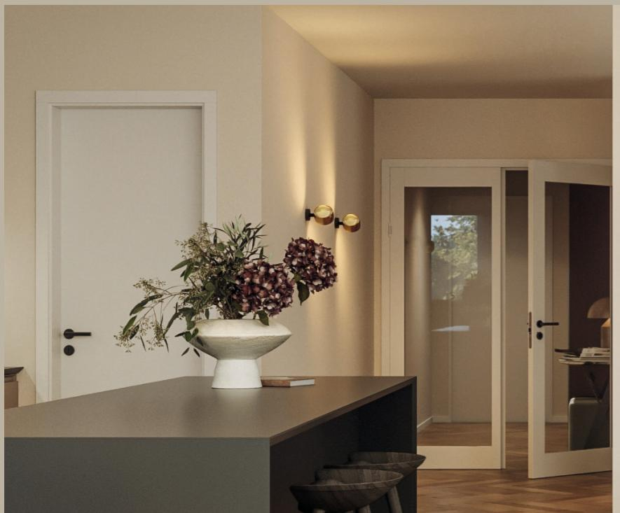
Die weißen, stumpf einschlagenden Türen wirken mit ihrer Höhe von 2,26 Metern klar und einladend. Holz-Aluminium-Fenster bieten eine langlebige, pflegeleichte Lösung mit guter Wärmedämmung. Edelstahl-Griffe an Fenstern und Türen unterstreichen das puristische Design konsequent.
